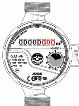
Rys. 3 Zalecana pozycja ustawienia mechanizmu zliczającego w zabudowie pionowej.
